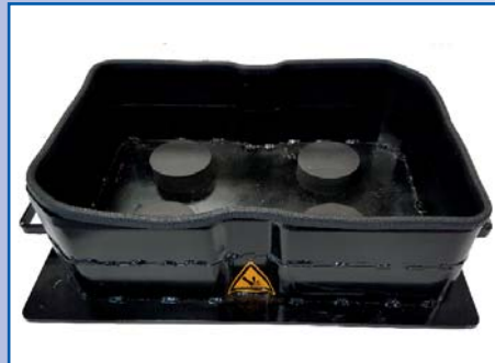
In der Höhe aufgestockte Stanzwerkzeuge für hohe Thermoformteile
